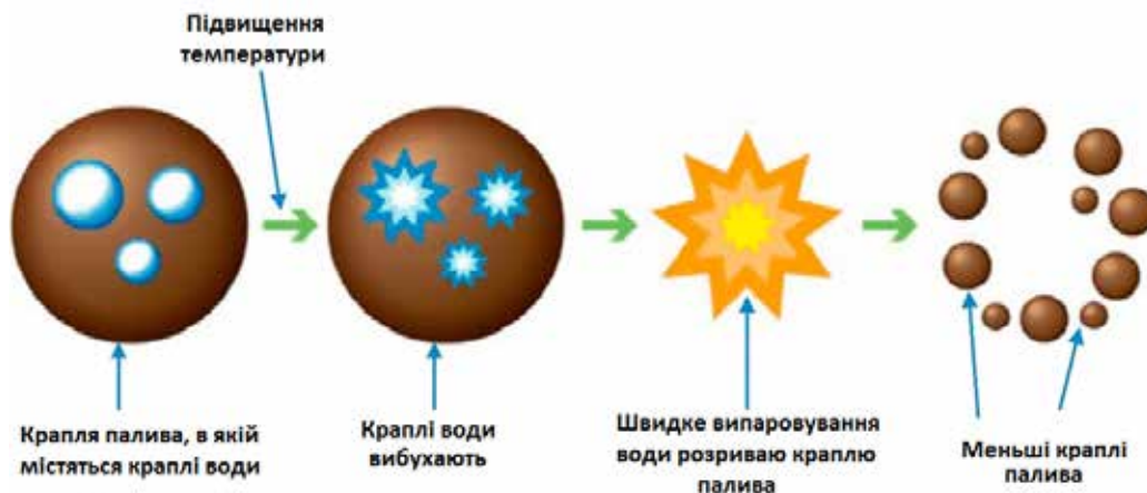
Рис. 1. Процес мікробибуху у водоемульсійному паливі
